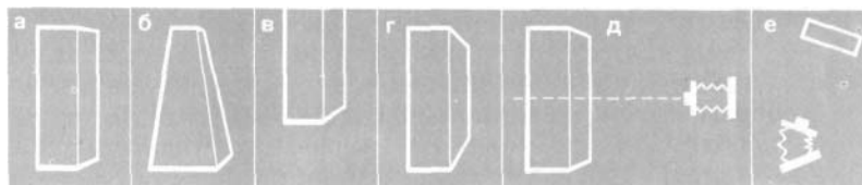
110 Съемка архитектуры. вертикальные границы здания параллельны краю кадра; б — перспективные сокращения при съемке с нижней точки; в — при съемке с близкой нижней точки; г — при перемещенном вверх объективе; д — оптимальное положение; е — использование поворота объектива
